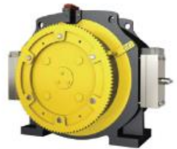
NIPPON Malaysia 4.1kw, pulley 320mm Cáp 4x8. Tải trọng 300kg
