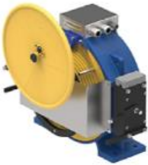
Montanari – MGX 75 4.1kw, pulley 320mm Cáp 4x8. Tải trọng 480kg
