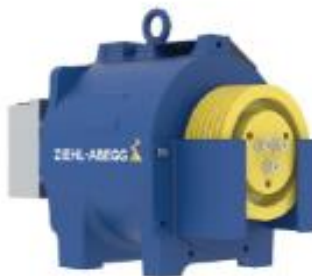
SM190.15C- Zielh abegg 4.4kw, pulley 240, Cáp 6x6.5. Tải trọng 630 kg
