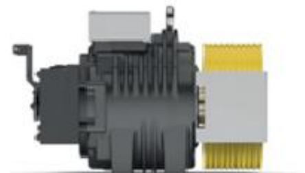
SICOR - SGS6135B 1.9kw, pulley 210 Cáp 4x6.5. Tải trọng 450kg,
