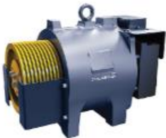
SM 160- Zielh abegg 3.9kw, pulley 320mm Cáp 4x8. Tải trọng 450kg
